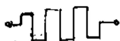
"R" che al passaggio della corrente disperde in calore l'energia assorbita e provoca la caduta di potenziale  $V = IR$
